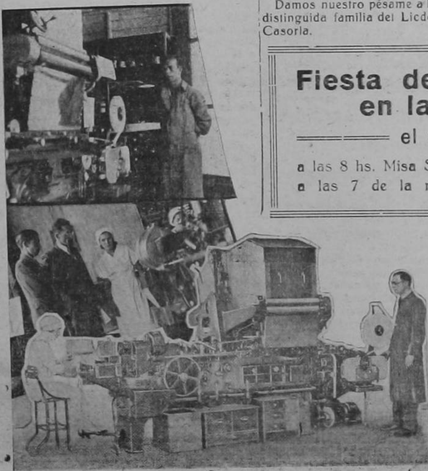
Presenta la composición gráfica: en la parte superior, parte de la magnífica máquina importada por la Tabacalera Costarricense con un experto nacional que tiene a su cargo el manejo de ella. Abajo: aspecto total de la máquina que elabora 600 cigarrillos por minuto, el gerente de la citada empresa don Mario Bengoechea explicando a uno de nuestros redactores su funcionamiento y las señoras que recogen los cigarrillos ya elaborados.
